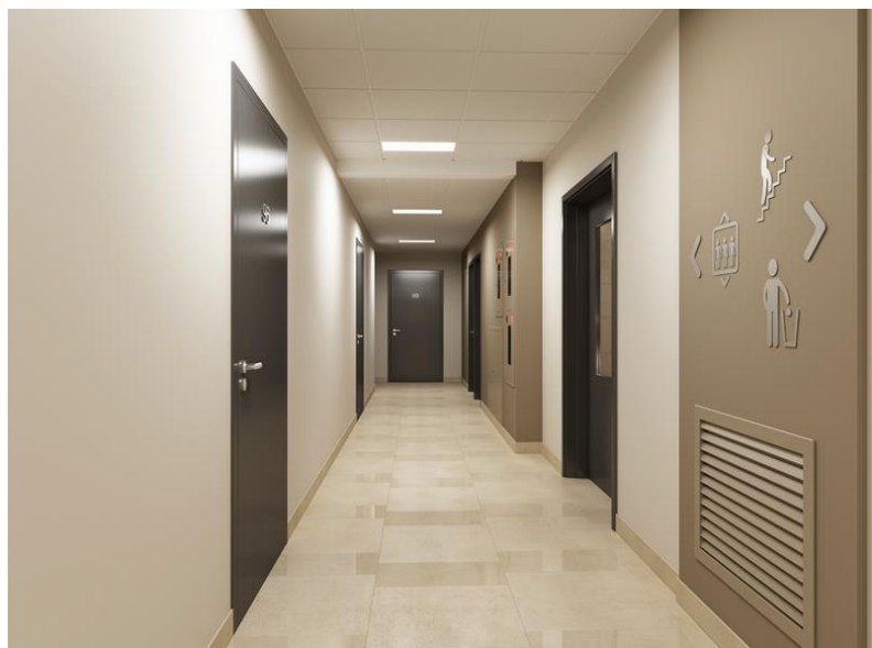
← Рис. Наглядный пример, как правильно должна размещаться решетка компенсации
