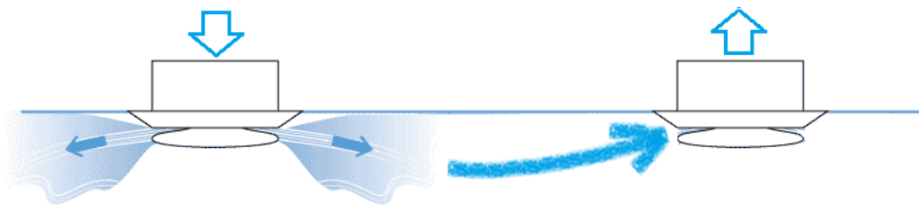
Рис. Приточные и вытяжные решетки нельзя размещать ближе 1,2-1,5 метров друг к другу, чтобы не «замыкать» воздушный поток
