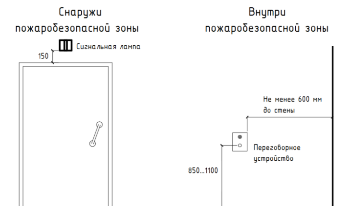
Рис. Правила установки переговорного устройства на примере пожаробезопасной зоны. Снаружи над дверью в это помещение должна быть установлена световая сигнализация
