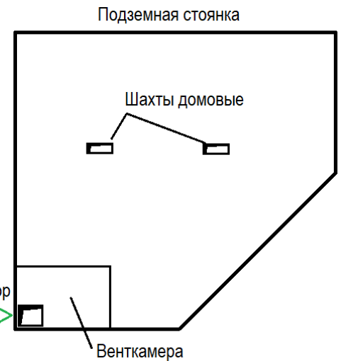
← Рис. Отличное решение - шахта из венткиоска опускается в подземную часть, где из строительных конструкций организовывается пространство (форкамера, где «фор» - от слова «перед», т.е. это предварительная камера), к которому подключаются десять вентиляторов
