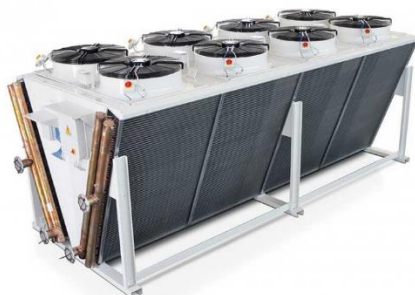
Рис. Слева - V образный драйкулер, справа – плоский. Функционально они ничем не отличаются, оба состоят из теплообменника (ов) и вентиляторов. В плоском – один теплообменник, а в V образном – два, расположенных наклонно. Это и позволяет ему занимать меньше площади кровли
