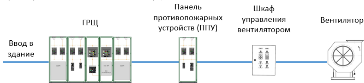
Рис. Схема электроснабжения вентилятора противодымной вентиляции
