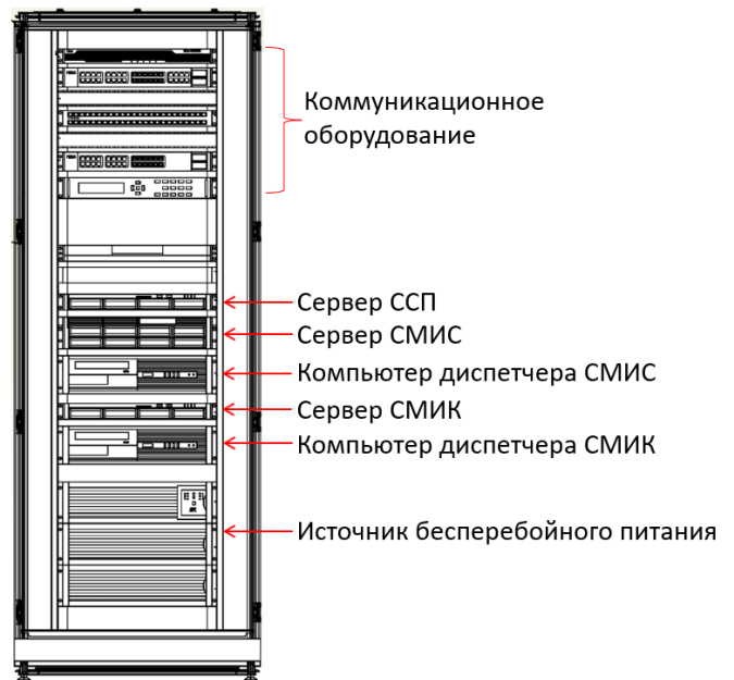
Рис. Стойка с основным оборудованием СМИС (→)
