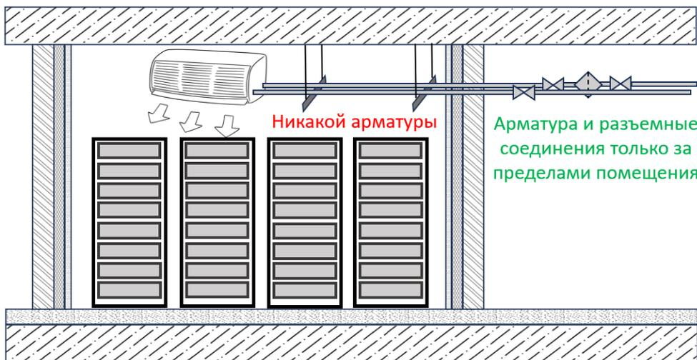
*Рис. В серверной могут находиться только трубопроводы, прокладываемые к оборудованию, обслуживающему эту серверную. При этом в границах помещения все трубопроводы должны быть без арматуры и разъемных соединений (все стыки – сварные или паяные). А вся арматура – строго за пределами серверной*
