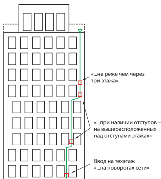
Рис. 9. Пример. Как видим, если читать СП буквально, то количество лючков на фасаде может быть велико, что не добавляет ему красоты
