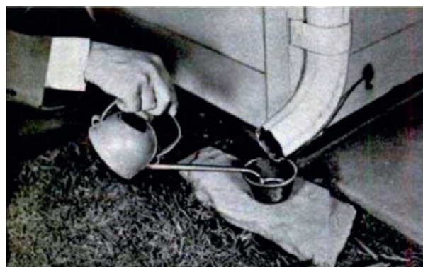
Рис. 2. Система закрывания окон при дожде
