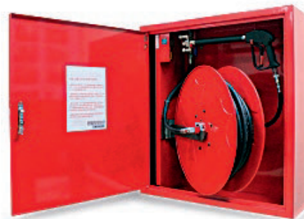
Рис. 5. Малорасходный пожарный кран для системы тушения тонкораспыленной водой высокого давления (ПК-м ТРВ ВД). В корпусе размещается катушка с пожарным рукавом высокого давления, а вместо пожарного ствола используется специальный пистолет-распылитель
