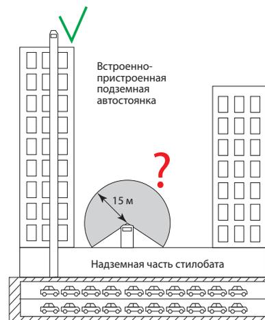
Рис. 5. Выброс необходимо выводить на кровлю самого высокого здания. Размещение на покрытии стоянки зависит от взгляда конкретного эксперта (п. 7.6.10 СП 60.13330.2020; п. 4, 6 СанПиН 2.2.1/2.1.1.1200-03)
