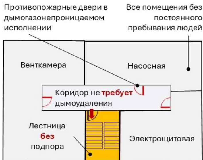
Рис. Два исключения, позволяющих не выполнять дымоудаление в коридорах
