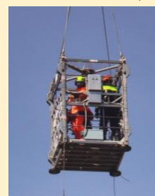
Транспортно-спасательная кабина ТСК-1 для эвакуации 2-х человек с балконов
