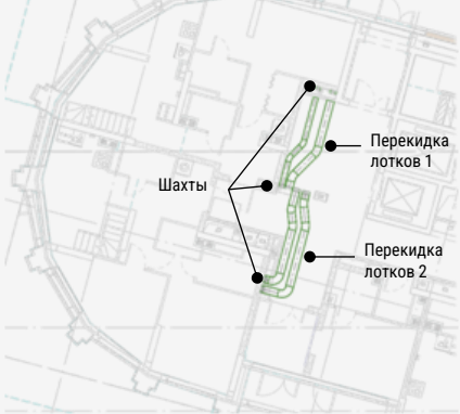
Пример перекидок лотков электроснабжения
