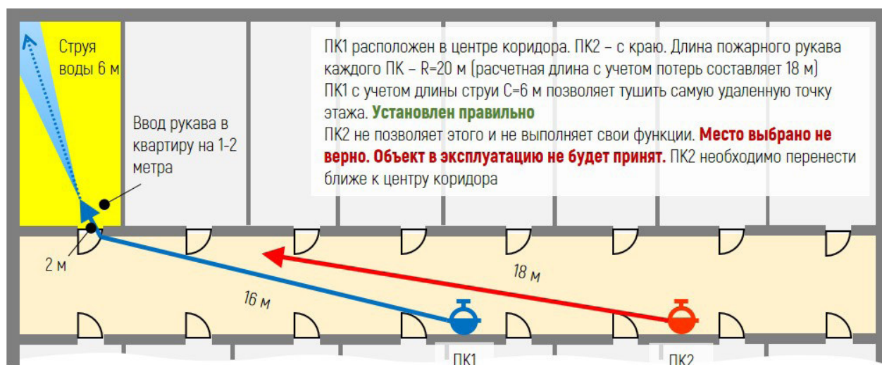
■ Рис. 11. Расчетная длина рукава составляет 18 м, к ней добавляется дальность струи в 6–8 м, что в сумме дает радиус действия пожарного крана
